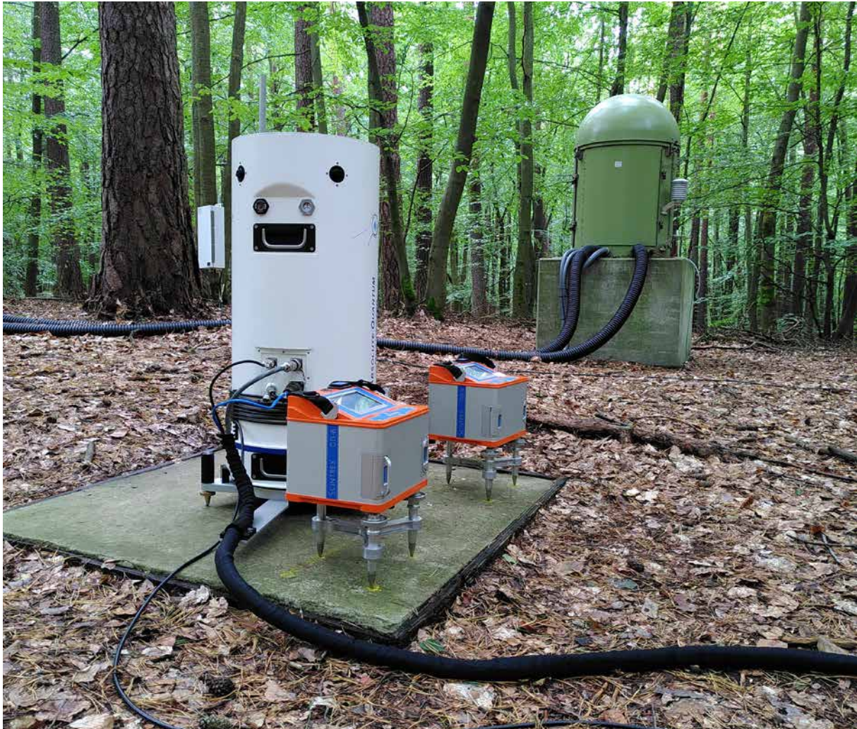
Verschiedene Gravimeter zur Bestimmung von Veränderungen der natürlichen Wasserspeicherung im TERENO-Observatorium in Nordostdeutschland, Standort „Serrahn“ (Bild: Marvin Reich/GFZ).
